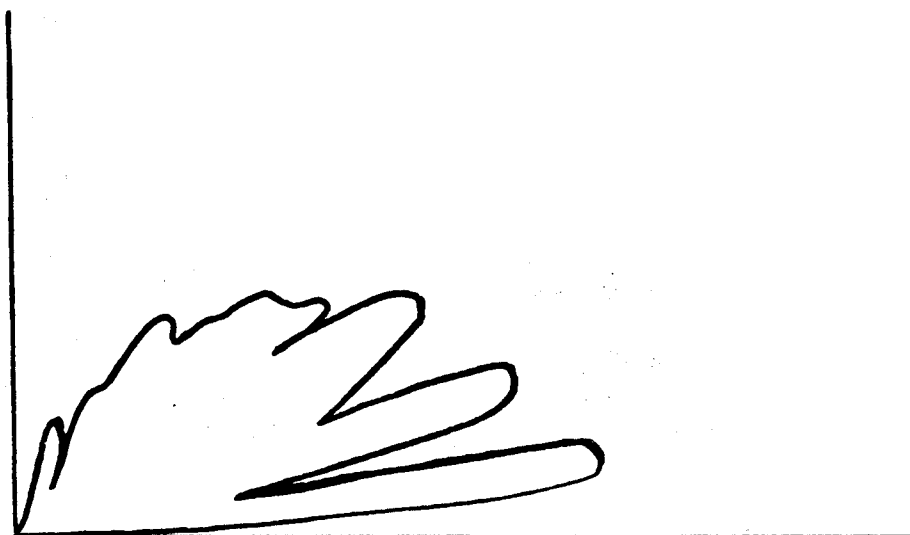
Auffächerung der Strahlungskennlinie über Land. (trockener Erdboden)
